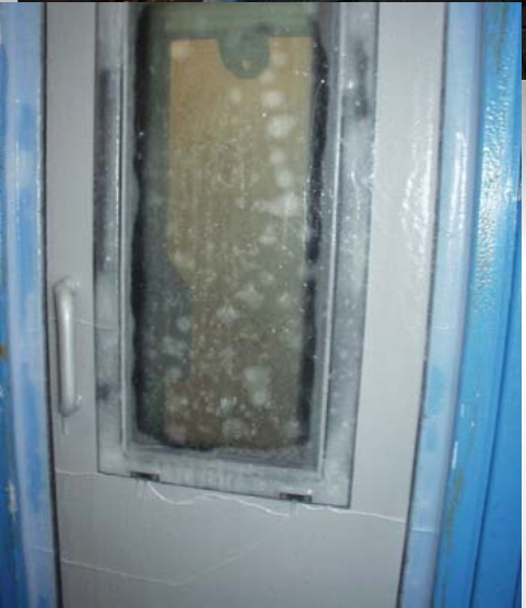
Typprüfung bei -40 °C Type test at -40 °C
