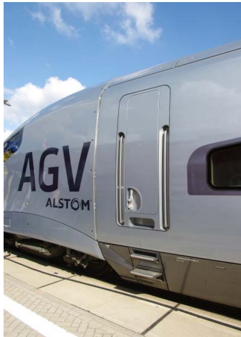
„AGV“, Einstiegstür Fahrerstand, Alstom “AGV“, Driver’s cab door, Alstom
