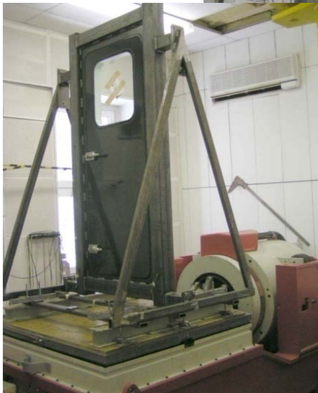
Schwingen und Schocken nach DIN EN 61373 Vibration and shock according to DIN EN 61373
